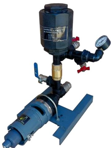
Modelo compacto de 32 mm para caudales de 10 a 30 litros/minuto. Indicado para desniveles de 1,20 a 8 metros y conducto de impulsión de 32 mm en adelante. Muy eficiente para pequeños caudales si se consigue una relación de alturas de 1/4. Altura máxima de elevación 45-50 metros.
