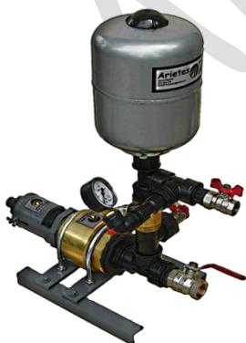
Modelo compacto de 32 mm para caudales de 30 a 60 litros/minuto. Indicado para desniveles de 2 a 20 metros y conducto de impulsión de 32 mm en adelante. Muy eficiente para pequeños caudales si se consigue una relación de alturas de 1/4. Altura máxima de elevación 75-80 metros.
