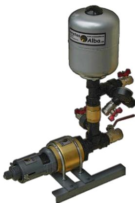
Modelo compacto con válvula de choque de 90 mm y conducto de impulsión de 40 mm. Diseñado para el ofrecer el máximo rendimiento en cualquier condición de trabajo por su versatilidad y posibilidad de personalizar el resorte. Muy eficiente en instalaciones pequeñas que tengan un caudal muy ajustado o poco desnivel siempre que se consiga una relación de alturas de 1/4. Caudal de trabajo de 30 a 130 litros/minuto. Altura máxima de elevación 75-80 metros.
